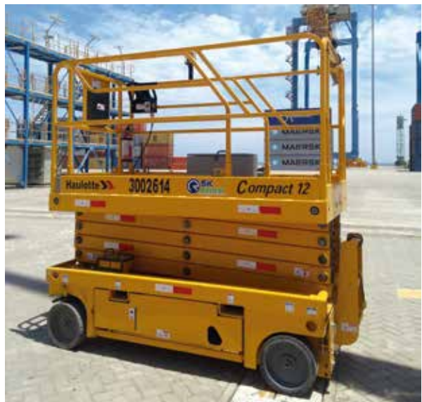
Estos equipos poseen un motor eléctrico, cuya batería debe cargar entre 6 a 24 horas para el inicio de la operación.
