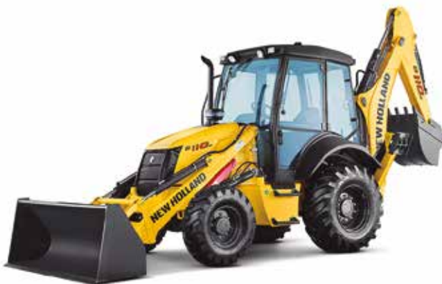
En la retroexcavadora B110B se aprecia una capacidad de elevación de 3,595 kg en la cuchara cargadora y una fuerza de rompimiento de 6,400 kg.
