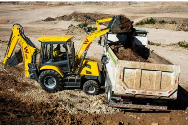
Gracias a su montaje en chapa de acero y diseño curvo, el brazo de la retroexcavadora BL744, de Wacker Neuson, puede soportar grandes esfuerzos y torsiones.
