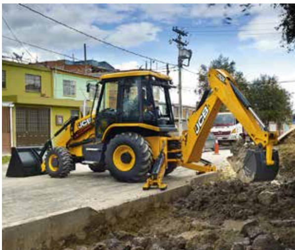
Las retroexcavadoras de JCB poseen una cuchara de carga de 1.1 m 3 , motor con inyección mecánica, estabilizadores protegidos y una óptima visibilidad para los operarios.
