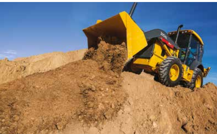
Las retroexcavadoras de John Deere utilizan un eje trasero ZF con frenos internos de disco húmedo autoajustables, mandos finales planetarios exteriores y traba de diferencial.
