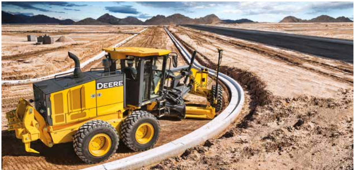
Este tipo de maquinaria pesada es empleada para la nivelación básica de suelos, ejecución de caminos, nivelación de terrenos agrícolas, construcción y limpieza de canales.
